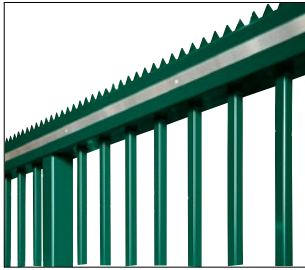
Übersteigschutz 50 mm hohe Zackenleiste, über die Gesamtlänge des Oberholms angeschweißt
