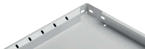
Tragfähigkeit 100 kg und 230 kg, mit Systemlochung, Kantenhöhe 40 mm
