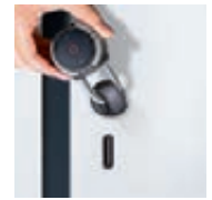
Sicherheits-Drehriegel-verschluss (dreht in verschlossenem Zustand durch und verhindert so das Aufbrechen durch Überdrehen)
