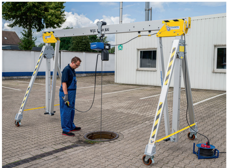
Elektrisch Heben und manuell verfahren
