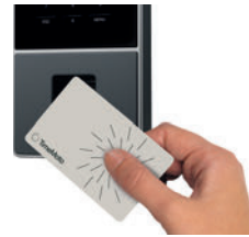
Ein- bzw. Ausloggen mit RFID-Ausweis
