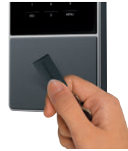
Ein- bzw. Ausloggen mit RFID-Anhänger
