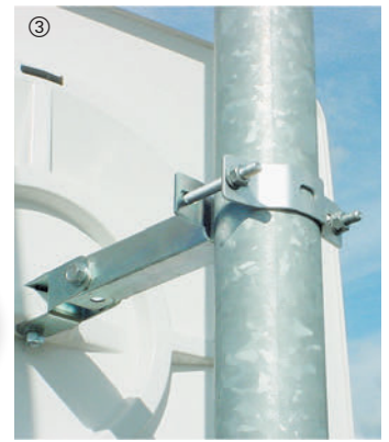
Universal-Halterung für Abb. ① (Ø 800 mm), im Lieferumfang enthalten. Für Wände und für Pfosten mit einem Durchmesser von 60-90 mm. Rohrfosten auf Anfrage lieferbar.
